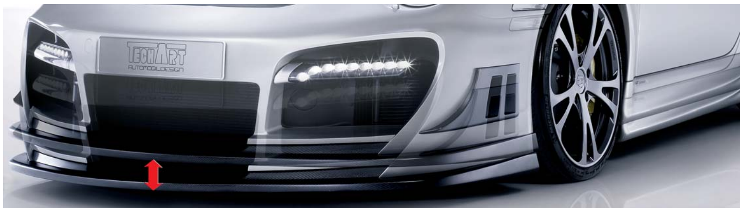
Mit dem TECHART Noselift System stehen bei Bedarf ca. 60 mm mehr Bodenfreiheit am Frontspoiler zur Verfügung. Dies ermöglicht das Überwinden alltäglicher Hindernisse ohne Aufsetzen. At the push of a button, the TECHART Noselift system provides approx. 60 mm of additional ground clearance at the front spoiler. This allows to override common humps without grounding.
