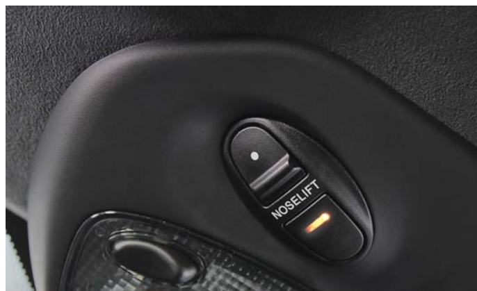
Perfekte Integration: der TECHART Noselift Schalter in der Dachbedieneinheit. Eine integrierte Statusanzeige informiert während des Verstellvorgangs (blinkend) sowie bei angehobenem Niveau (leuchtend). Perfect integration: the TECHART Noselift button at the roof console. An integrated status LED indicates lifting in progress (flashing) and raised ride-height (steady light).
