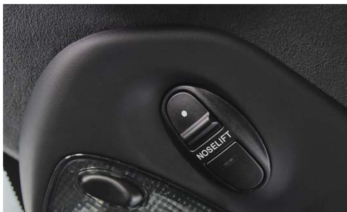
Perfekte Integration: der TECHART Noselift Schalter in der Dachbedieneinheit. Eine integrierte Statusanzeige informiert während des Verstellvorgangs (blinkend) sowie bei angehobenem Niveau (leuchtend). Perfect integration: the TECHART Noselift button at the roof console. An integrated status LED indicates lifting in progress (flashing) and raised ride-height (steady light).
