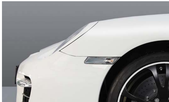
Mit dem TECHART Noselift System stehen bei Bedarf ca. 60 mm mehr Bodenfreiheit am Frontspoiler zur Verfügung. Dies ermöglicht das Überwinden alltäglicher Hindernisse ohne Aufsetzen. At the push of a button, the TECHART Noselift system provides approx. 60 mm of additional ground clearance at the front spoiler. This allows to override common humps without grounding.
