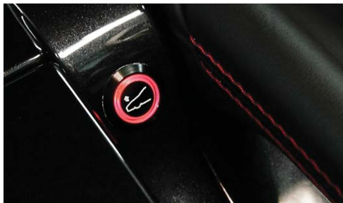
Perfekte Integration: der TECHART Noselift Schalter befindet sich bei Porsche 911 und Boxster in der Dachbedieneinheit (links), bei Cayman Modellen in der Mittelkonsole (rechts). Perfect integration: the TECHART Noselift button for the Porsche 911 and Boxster is located at the roof console (left), for the Cayman models at the center console.
