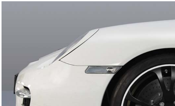
Mit dem TECHART Noselift System stehen bei Bedarf ca. 60 mm mehr Bodenfreiheit am Frontspoiler zur Verfügung. Dies ermöglicht das Überwinden alltäglicher Hindernisse ohne Aufsetzen. At the push of a button, the TECHART Noselift system provides approx. 60 mm of additional ground clearance at the front spoiler. This allows to override common humps without grounding.
