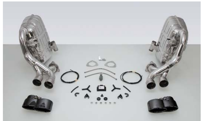
TECHART Sportabgasanlage mit Sportendrohren in Schwarzchrom für Porsche 911 S Modelle TECHART sport exhaust system with black chrome tailpipes for the Porsche 911 S models
